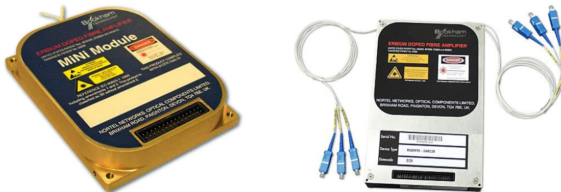
Rys.7.30 (a) Schemat optycznego wzmacniacza światłowodowego, (b) wygląd handlowo dostępnych wzmacniaczy EDFA
