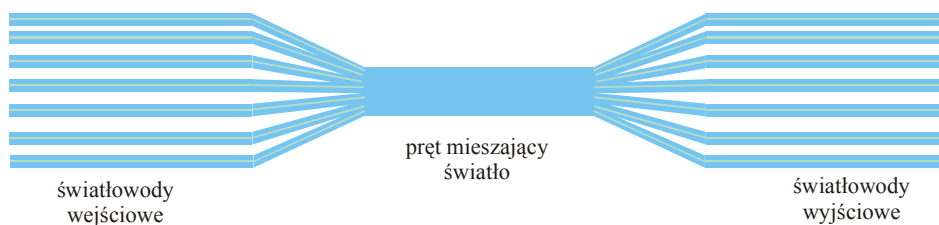
Rys.7.8 Ilustracja sprzęgacza N \times N , który powstaje przez stopnienie i wyciągnięcie wielu światłowodów
